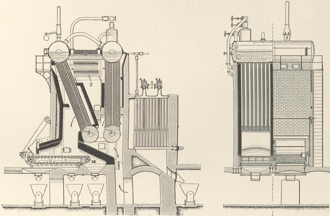
Fig. 90. Garbekessel der Düsseldorf-Ratinger Röhrenkesselfabrik.
