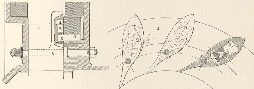
Fig. 50. Drehschaufelkonstruktion.
