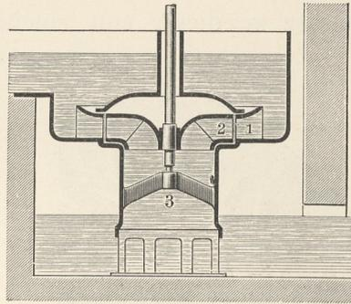
Fig. 46. Schnitt durch eine Francisturbine mit Saugrohr.
