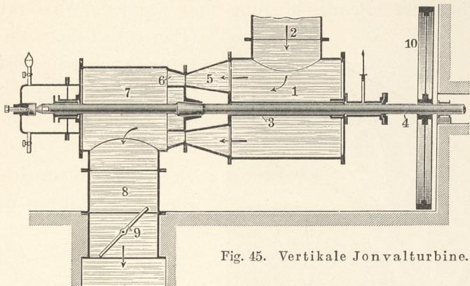
Fig. 45. Vertikale Jonvalturbine.
