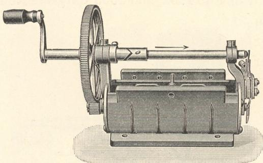
Fig. 1335. Magnetinduktor.
