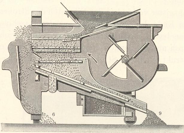
Fig. 861. Getreidereinigungsmaschine von H. Dreyer, Osnabrück (Längsschnitt): 1 Aufschütttrichter, 2 Rostenspreusieb, 3 Spreusieb, 4 Ventilator, 5 feines Spreusieb, 6 Ausscheidungsplatz aller größeren Unreinigkeiten, 7 Bodensieb zur Ausscheidung von Sand und Unkraut, die sich in 8 sammeln, 9 das gereinigte Getreide, 10 Ablaufstelle der leichten Körner, wenn die Getreidereinigungsmaschine nach Wegnahme der Siebe 2, 3 und 5 als Windfège benutzt wird.
