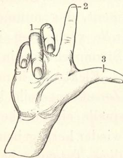
Fig. 304. Fleming'sche Drei-Finger-Regel. (1 Stromrichtung, 2 Kraftlinienrichtung, 3 Bewegungsrichtung.)
