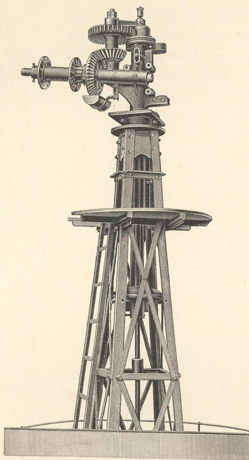
Fig. 19. Motorkörper der Windturbine.
