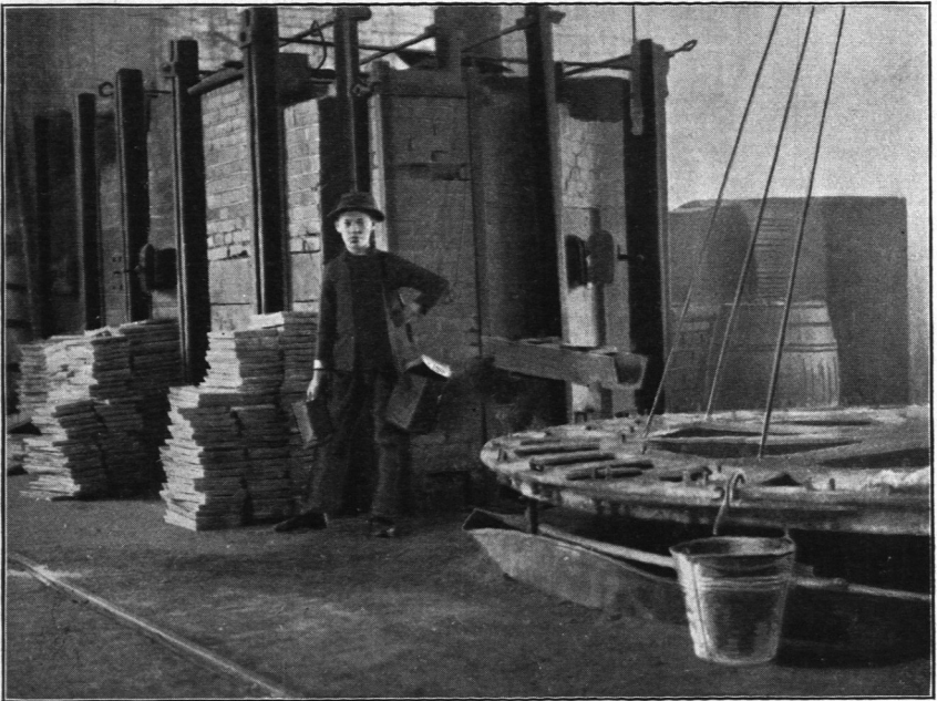
Fig. 132. Zinkraffinierofen mit Gießtisch, Ansicht.
