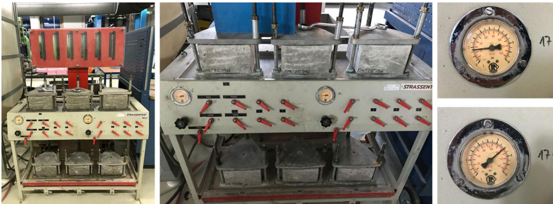
Abbildung 58: WU Prüfung – Einbau der Probekörper in die Prüfmaschine
