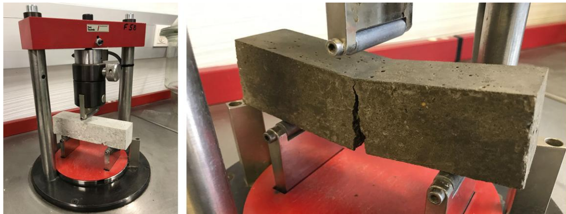
Abbildung 53: Drei-Punkt-Biegezugfestigkeitsprüfung an Mörtel Prismen
