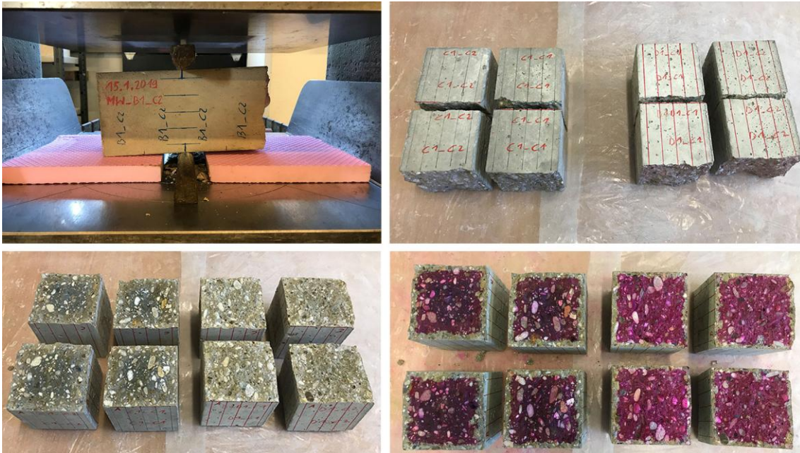
Abbildung 55: Brechen der Probekörper und Besprühen mit Indikatorlösung Phenolphthalein
