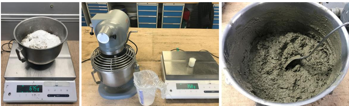
Abbildung 49: Mörtelherstellung – Einwaage und Mischen der verwendeten Stoffe
