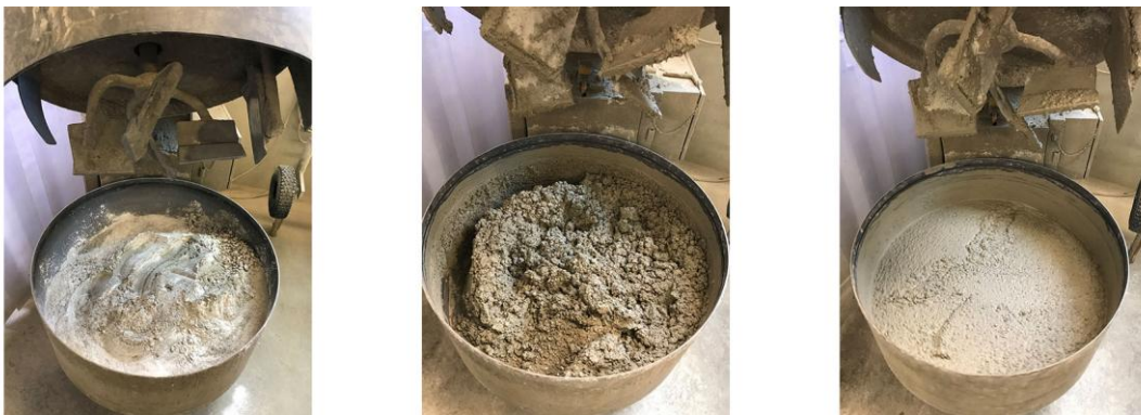
Abbildung 33: Mischen der einzelnen Stoffe trocken, mit Wasser und mit FM (links nach rechts)
