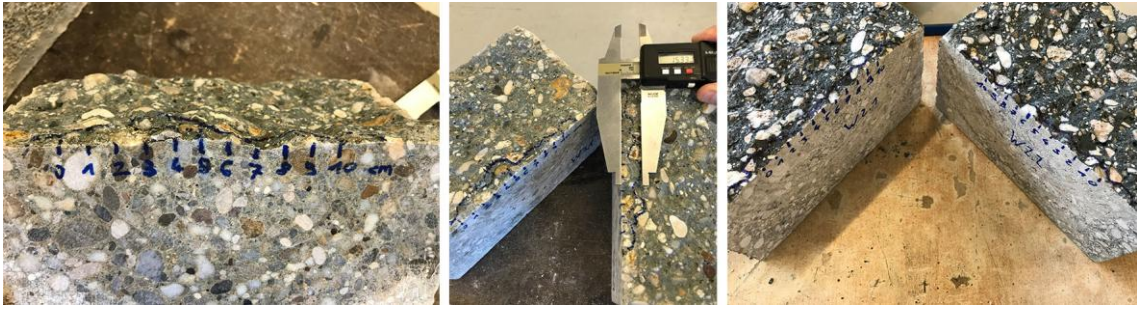
Abbildung 60: WU Prüfung - Durchführung der Messungen
