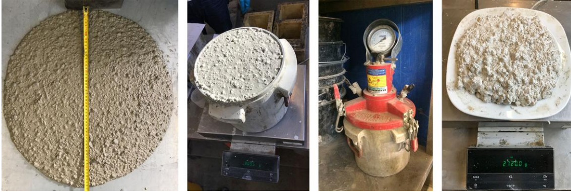
Abbildung 34: Frischbetonprüfung - Ausbreitmaß, Rohdichte, Luftgehalt, Gesamtwassergehalt
