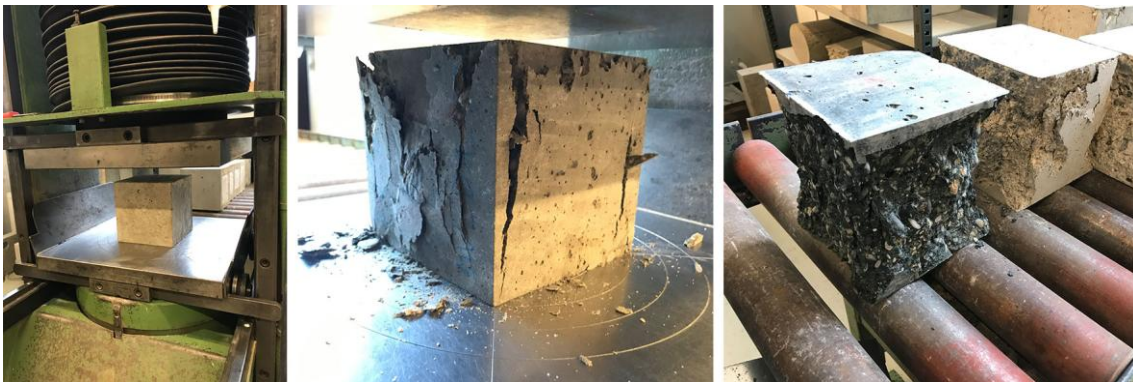
Abbildung 37: Druckfestigkeitsprüfung am Beton Probewürfel W150
