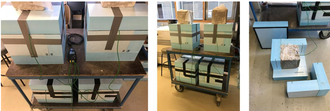
Abbildung 36: Temperaturmessungen im Kern der wärmeisolierten Betonproben
