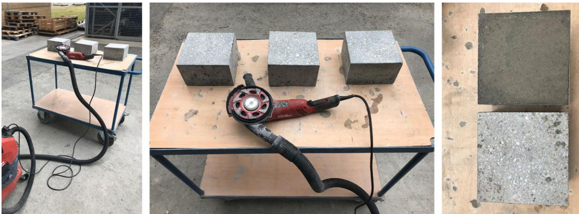
Abbildung 57: WU Prüfung – Probekörpervorbereitung und Einbau in die Prüfmaschine
