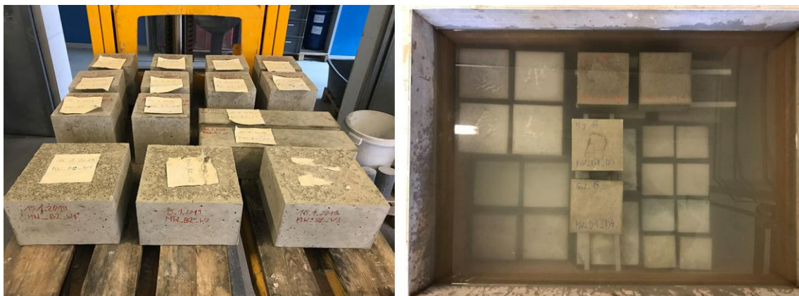
Abbildung 35: Beton Probekörperlagerung Unterwasser nach dem Ausschalen
