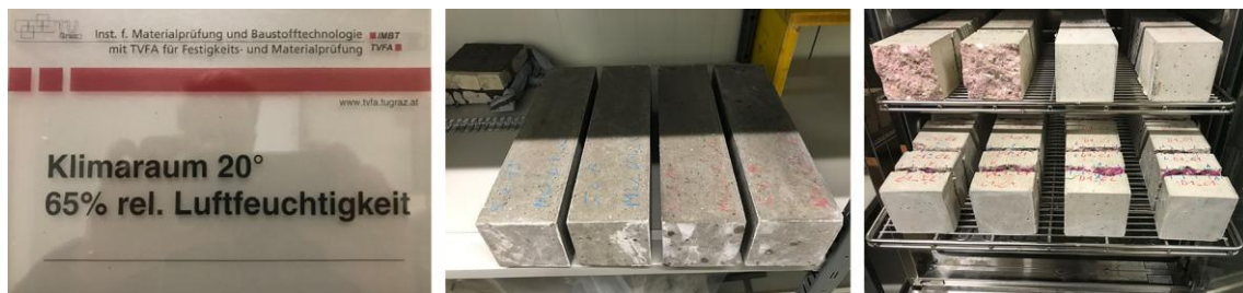
Abbildung 54: Vorlagerung im Klimaraum (links) und Versuchslagerung im CO 2 Schrank (rechts)
