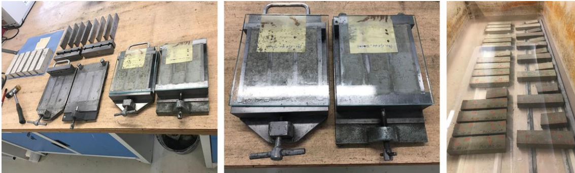
Abbildung 51: Mörtel - Lagerung in der Stahlform und unter Wasser
