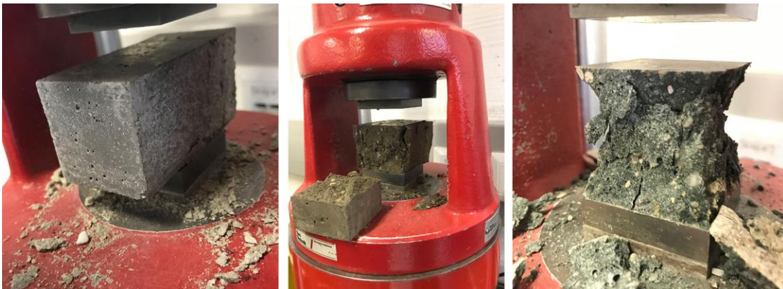
Abbildung 52: Druckfestigkeitsprüfung an Mörtel-Prismen-Hälften
