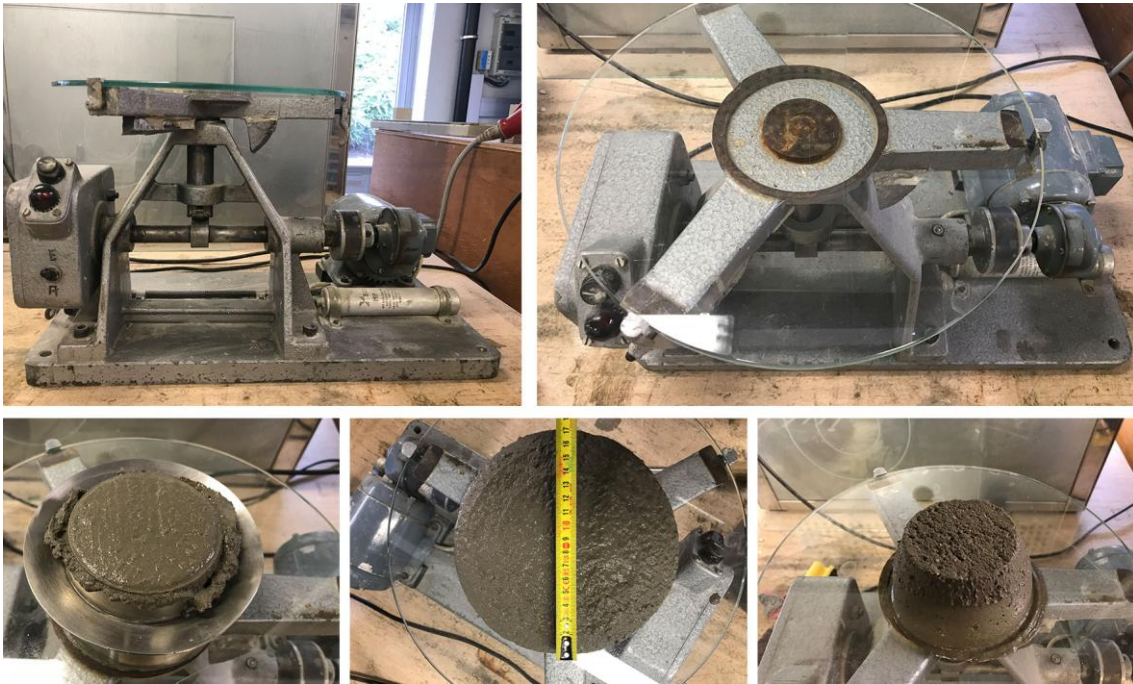
Abbildung 50: Untersuchung der Mörtelkonsistenz – Ausbreitfließmaß und Ausbreitmaß
