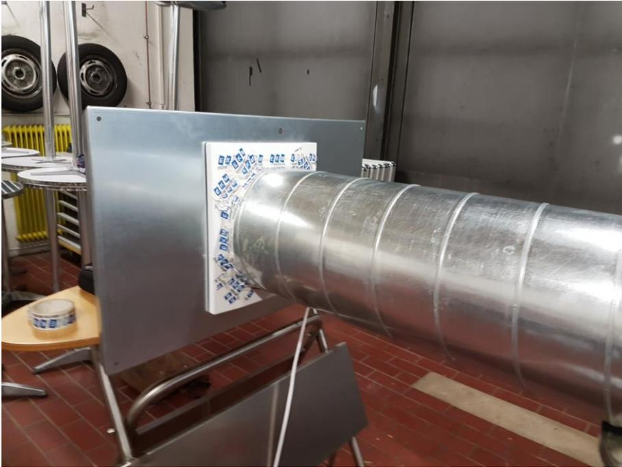
Bild 4.8 Foto des Aufbaus der Volumenstrommessung im Saugbetrieb
