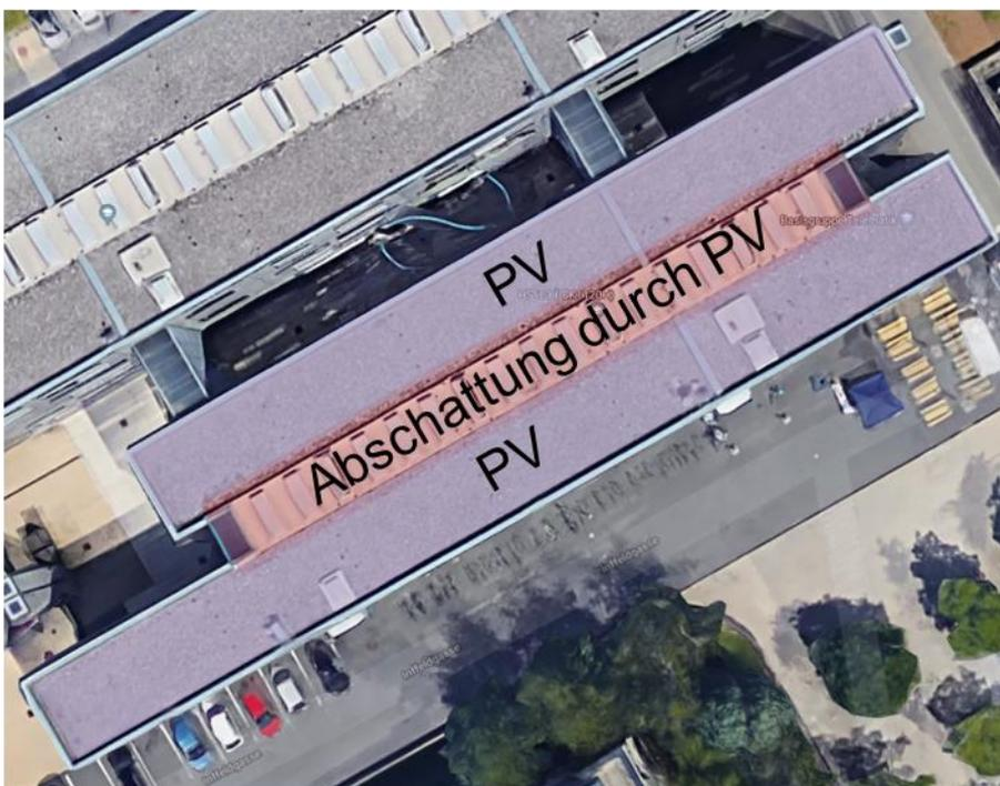
Bild 3.11 Skizze der geplanten PV-Anlage über dem Testgebäude<sup>72</sup>
