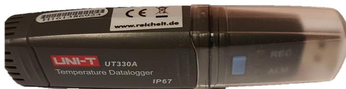
Bild 4.1 Foto: Verwendeter Datenlogger UNI-T UT330A
