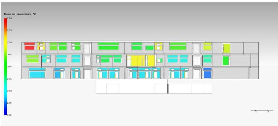
Bild B.19 Nordwestseite der Variante Verschattungsmaßnahmen mit farblicher Darstellung der Raumlufttemperatur
