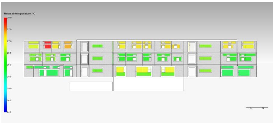
Bild B.21 Südostseite der Variante Verschattungsmaßnahmen mit farblicher Darstellung der Raumlufthtemperatur
