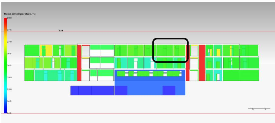
**Bild 7.28 Schnitt in der Südostseite der Variante Druckbetrieb mit farblicher Darstellung der Raumlufthtemperatur**
