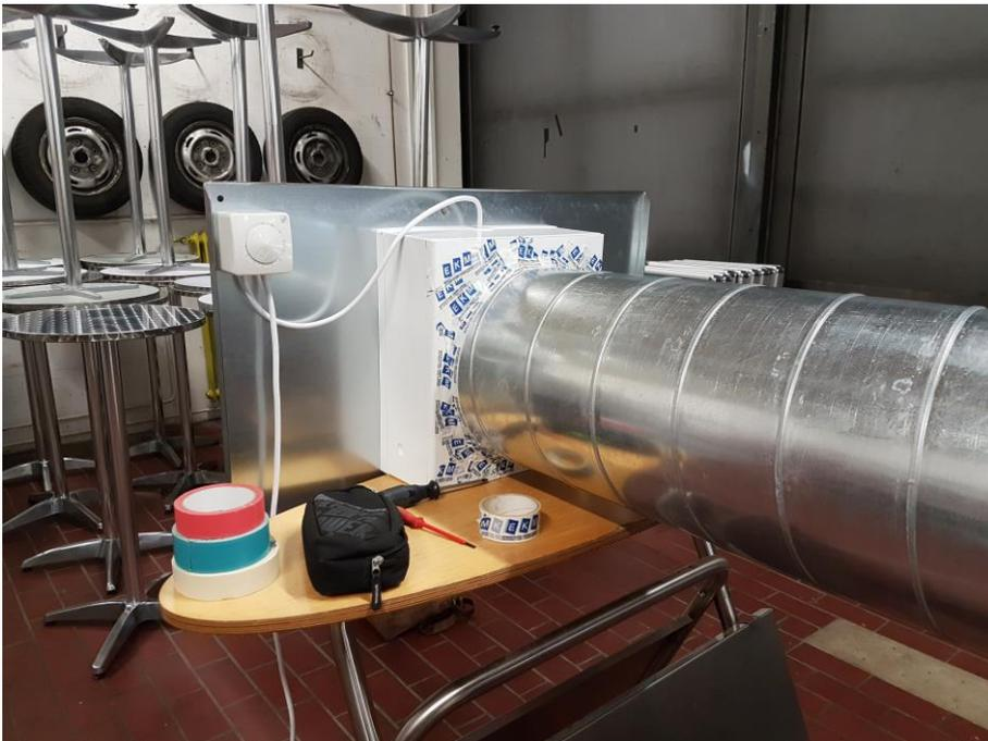
Bild 4.9 Foto des Aufbaus der Volumenstrommessung im Druckbetrieb
