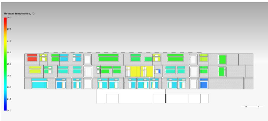
Bild B.25 Nordwestseite der Variante Saugbetrieb mit farblicher Darstellung der Raumlufttemperatur
