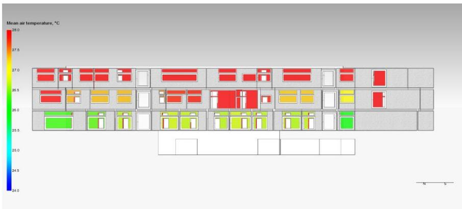
Bild B.12 Nordwestseite der Variante ohne Maßnahmen mit farblicher Darstellung der Raumlufttemperatur
