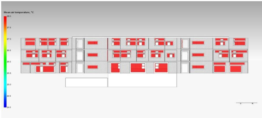
Bild B.14 Südostseite der Variante ohne Maßnahmen mit farblicher Darstellung der Raumlufttemperatur
