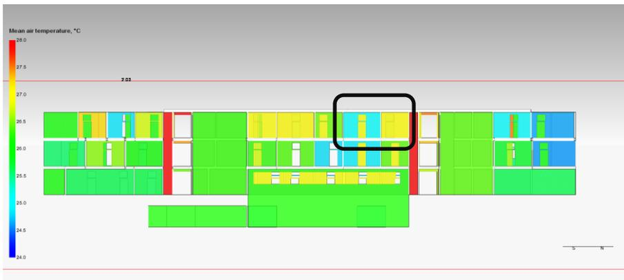
**Bild 7.22** Schnitt in der Südostseite der Variante Saugbetrieb mit farblicher Darstellung der Raumlufthtemperatur
