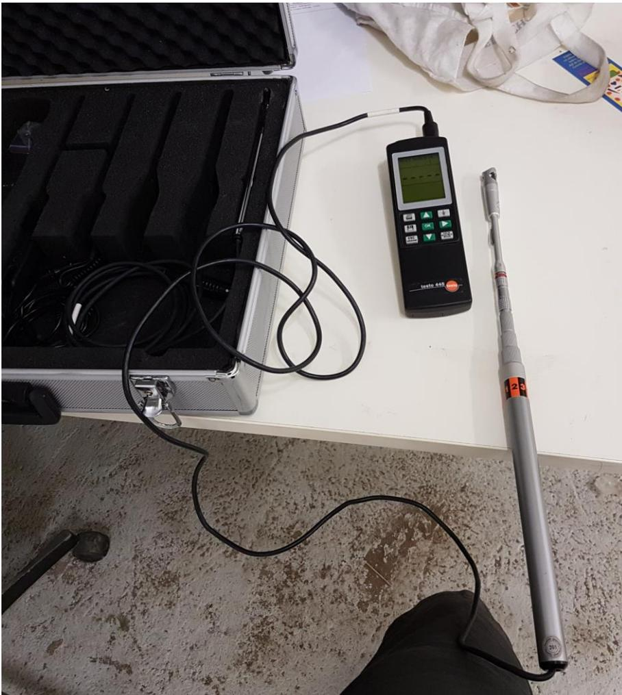
Bild 4.2 Foto des verwendeten Flügelradanemometers
