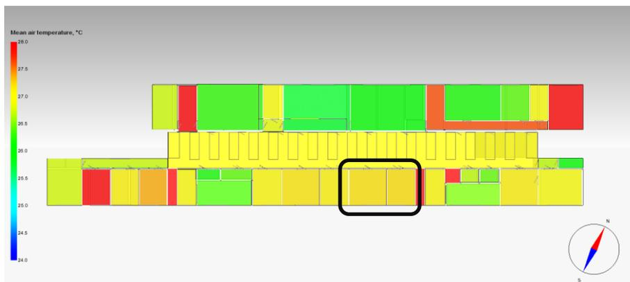
Bild 7.15 Grundriss 2. Obergeschoss der Variante Verschattungsmaßnahmen mit farblicher Darstellung der Raumlufttemperatur
