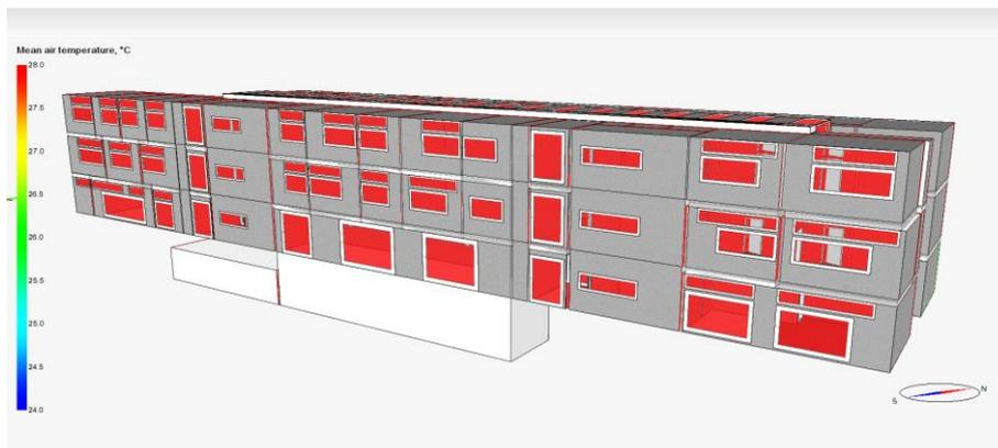
Bild 7.9 3D Ansicht der Variante ohne Maßnahmen mit farblicher Darstellung der Raumlufttemperatur
