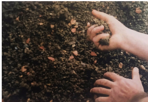
Abb.78 Handprüfung der Materialfeuchte vor dem Einbau
