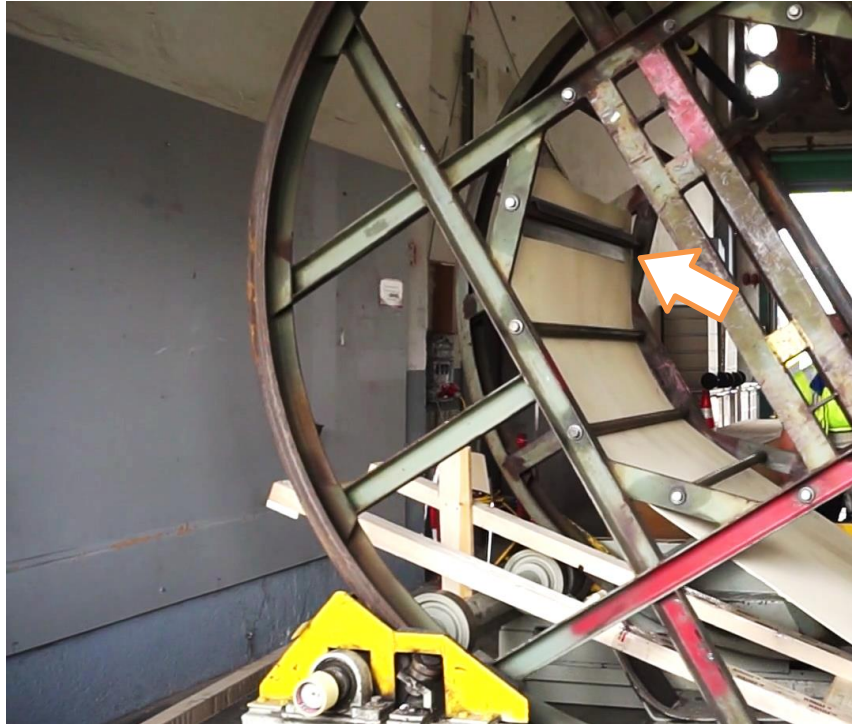
Abbildung 19: Einhaken mittels aufgeklebtem U-Profil, Quelle: Eigene Darstellung.
