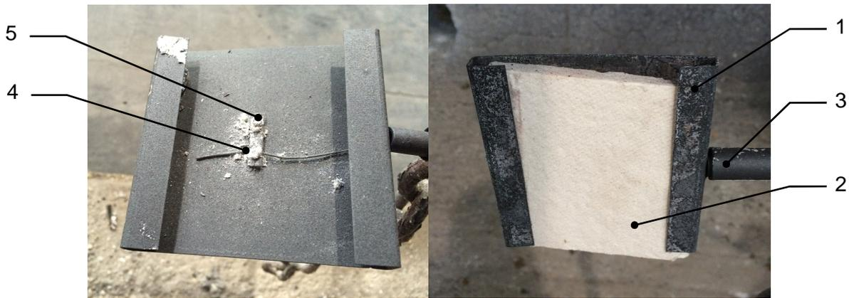
Abb. 3.3: Platten-Thermoelement
