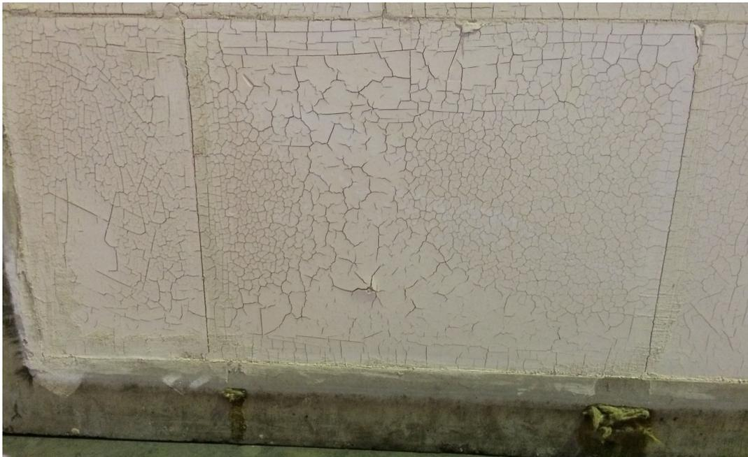
Abb. 3.7: Risse an der Probekörper-Innenseite
