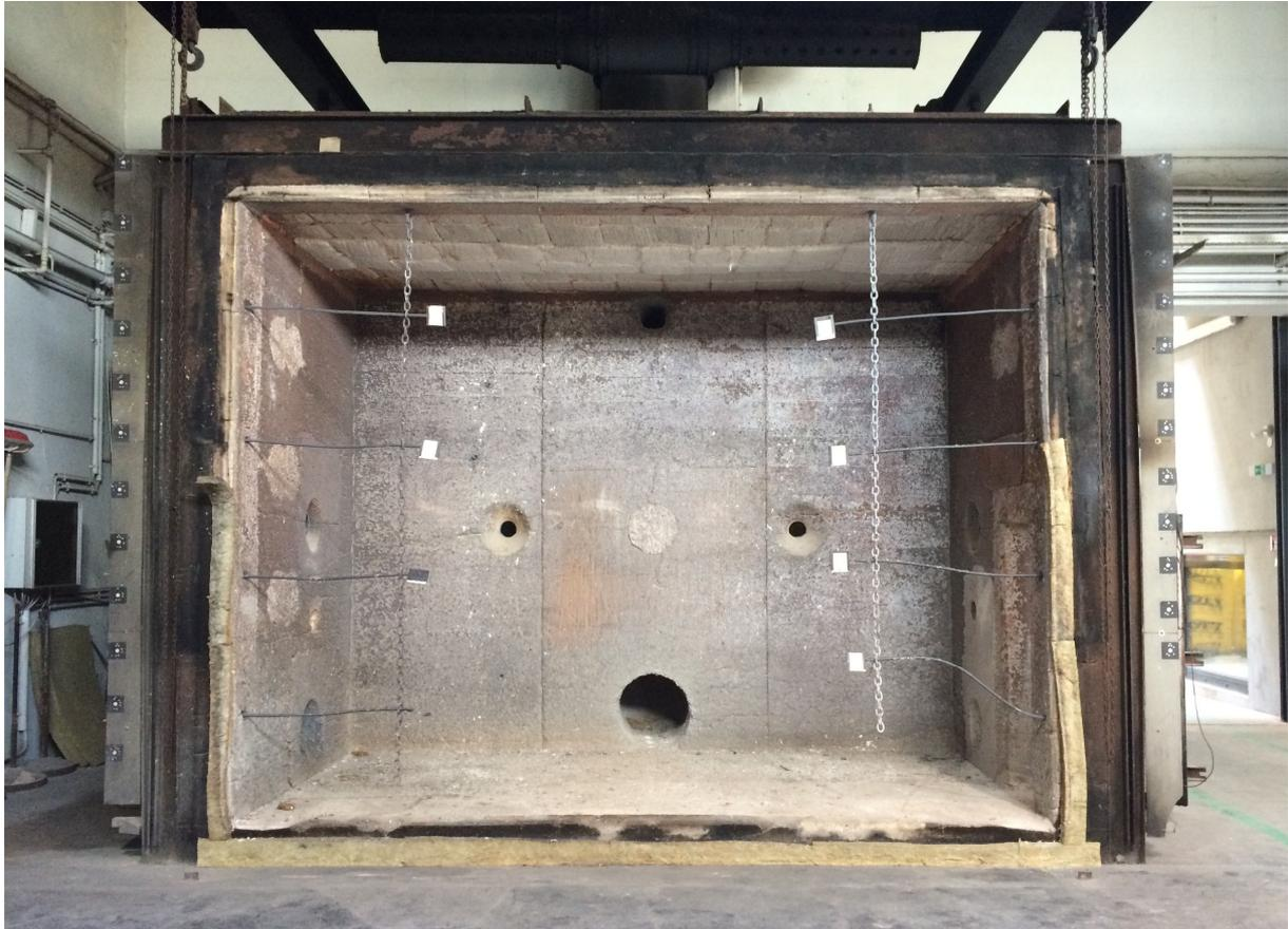
Abb. 1.3: Ofen für Feuerwiderstandsprüfungen
