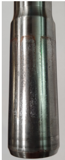
(a) Einspannbereich des Probekörpers
