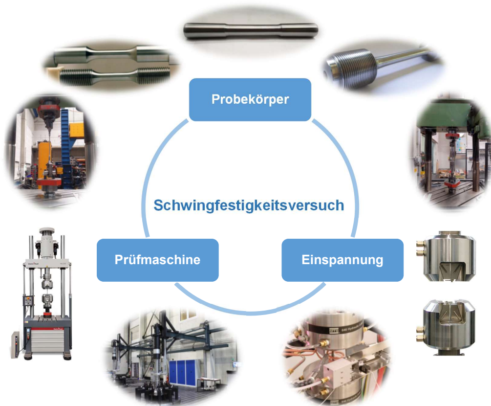
Abbildung 1.2: Standbeine des Schwingfestigkeitsversuchs: Probekörper, Einspannung und Prüfmaschine [Mah11; AG19b]
