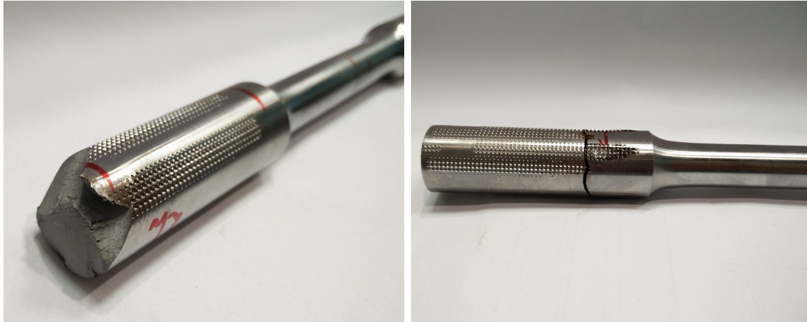
Abbildung 1.3: Unzulässig im Einspannbereich gebrochene Proben
