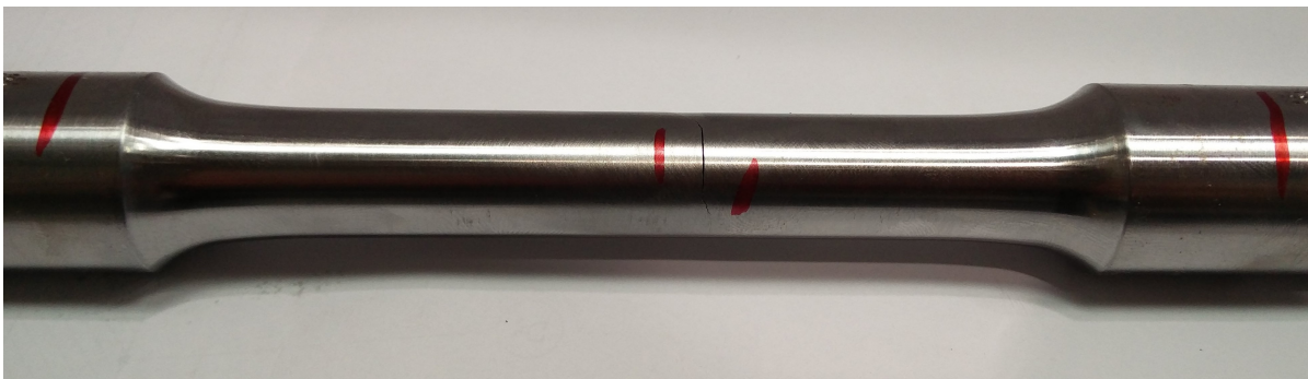
Abbildung 1.4: Zulässiger Probenbruch im Prüfquerschnitt
