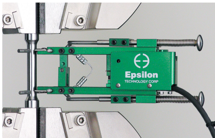
Abbildung 3.11: Verwendetes Extensometer [cor19]
