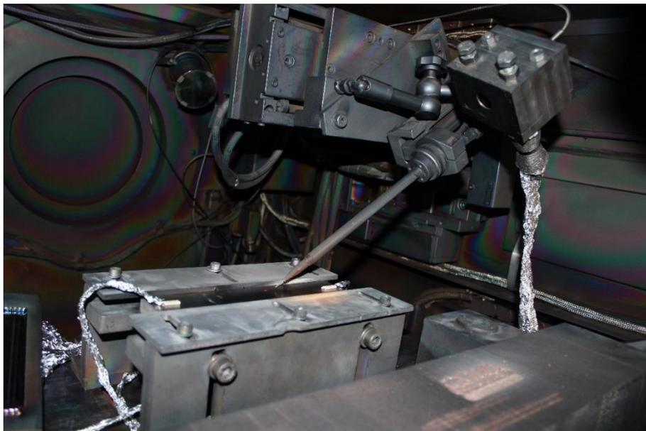
Abbildung 23: Versuchsaufbau 1 für Wände und Blöcke (Abstand 280mm und einem Winkel von ca. 50°)
