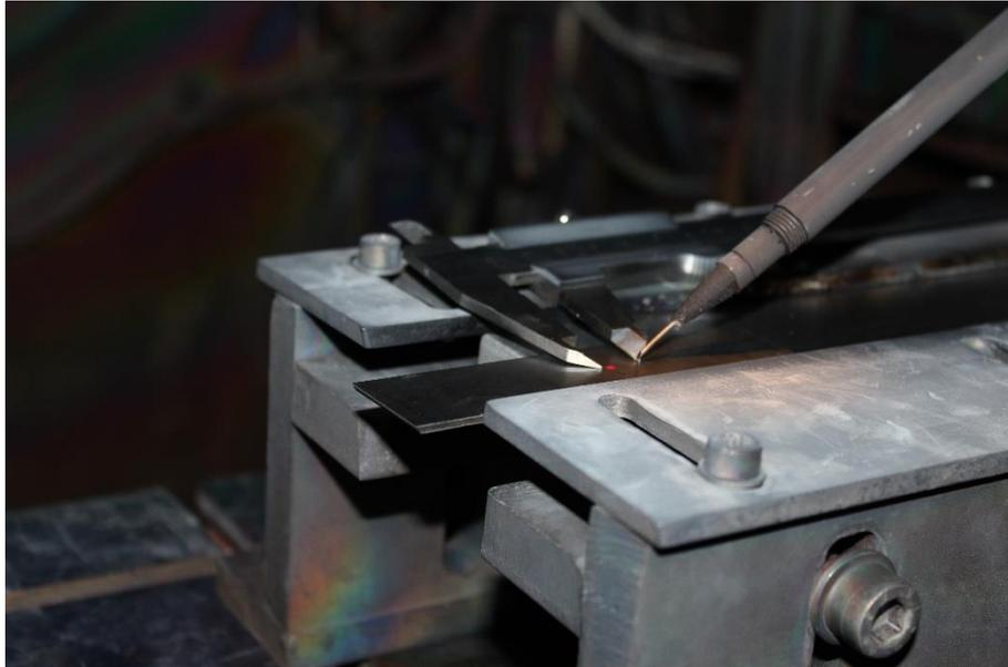
Abbildung 22: Bestimmung der Messabstände beim Mehrlagenaufbau
