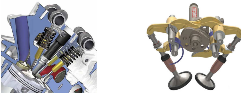
Abbildung 3-6 Klassische (links) und Zwangs-Ventilsteuerung (rechts)
