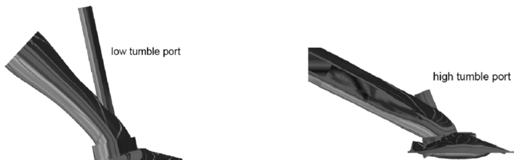
Abbildung 3-18 Einlasskanalgeometrien: links Füllkanal, rechts Tumblekanal
