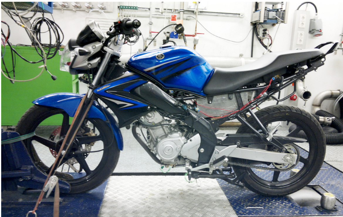
Abbildung 3-1: Versuchsfahrzeug Yamaha FZ 150i am Rollenprüfstand
