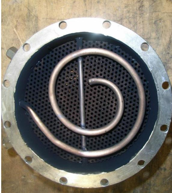
Abbildung 0.5: Spiralförmige Eindosierung
