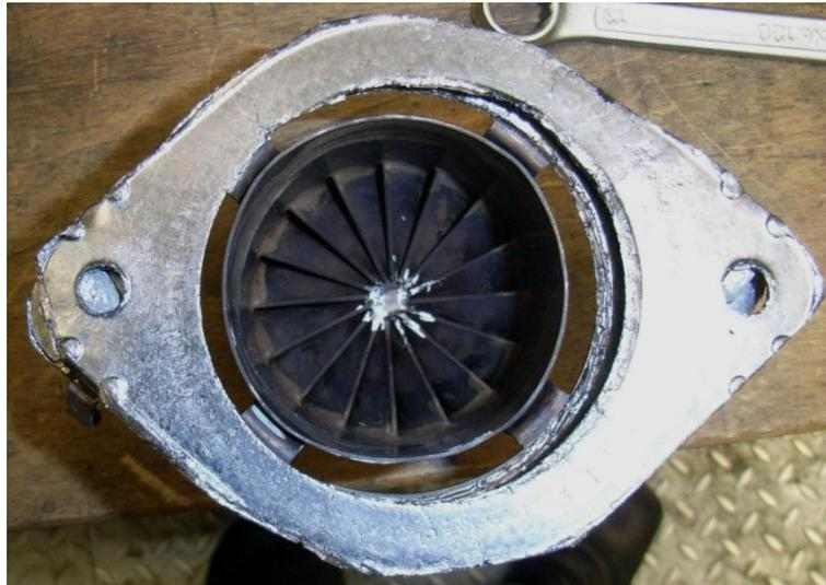
Abbildung 4.2: Mischblech zur gleichmäßigen Verteilung des eingebrachten  $\text{NH}_3$
