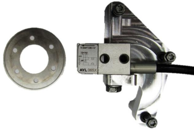
Abbildung 8-2: Drehwinkelaufnehmer
