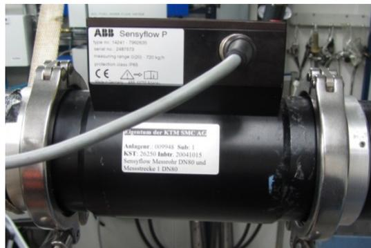
Abbildung 8-8: ABB Sensyflow
