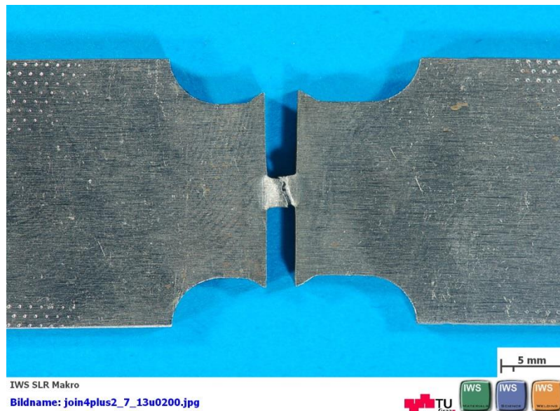
Abbildung 4-19: Gültiger Zugversuch (Probe: Z_130_5_9_02).
