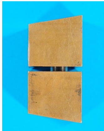
Abbildung 3-2: Spannbackenpaar mit eingebrachtem Bolzen.
