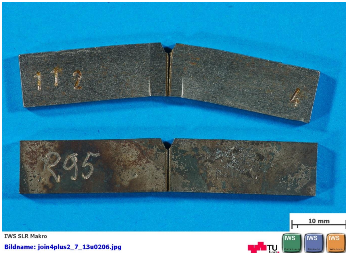
Abbildung 4-35: Vergleich einer Gleeble- (oben) und WEZ- (unten) simulierten Kerbschlagbiegeprobe ( T_S=1150 °C; t_{8/5}=1-2 s).
