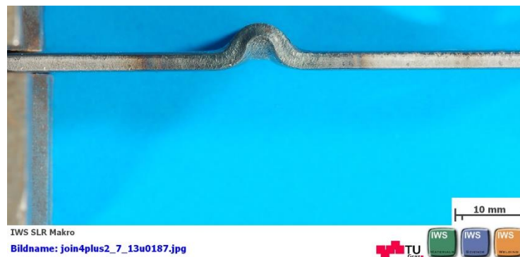
Abbildung 3-7: Ausgeknickte Vorversuchsprobe beim Warmstauchvorversuch.
