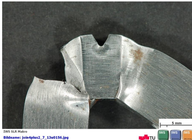
Abbildung 4-24: Kerbschlagbiegeprobe mit Riss im Grundwerkstoff (Variante 1) vom Versuch K_115_2_9_01.
