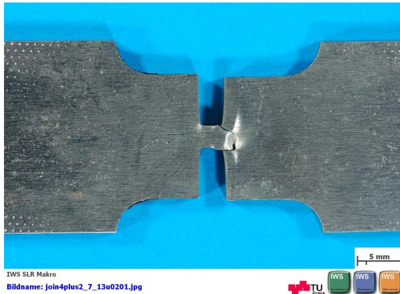
Abbildung 4-18: Ungültiger Zugversuch (Probe: Z_95_2_9_01).
