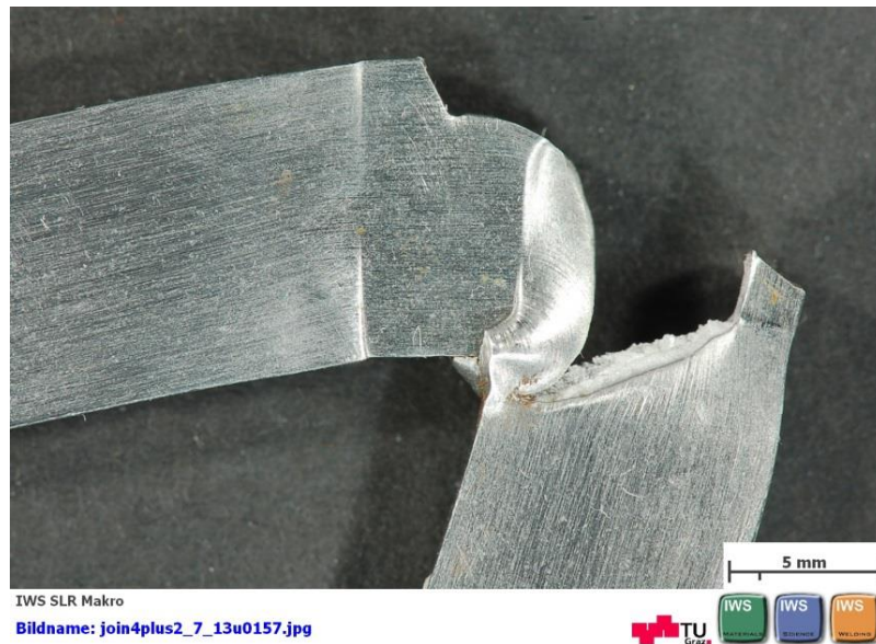
Abbildung 4-25: Kerbschlagbiegeprobe mit Rissstart im Kerbgrund und anschließendem Verlauf im Grundwerkstoff (Variante 2) vom Versuch K_115_2_9_02.
