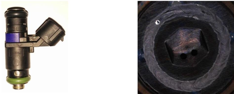
Abbildung 4.10 Injektor (links) und Einspritzöffnungen (rechts)
