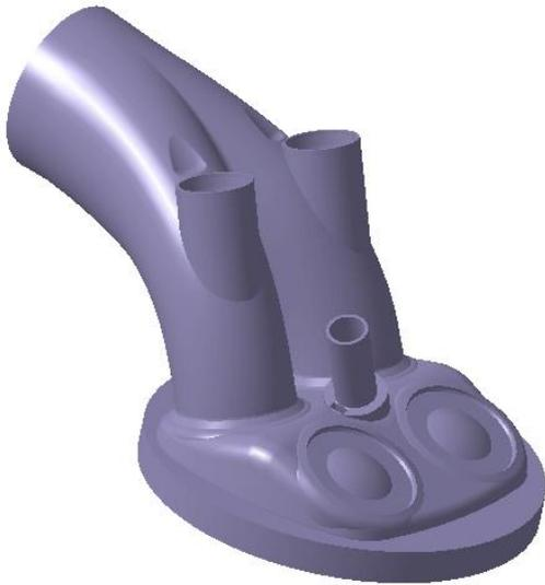
Abbildung 3.2 FZ150 Brennraum mit Einlasskanäle
