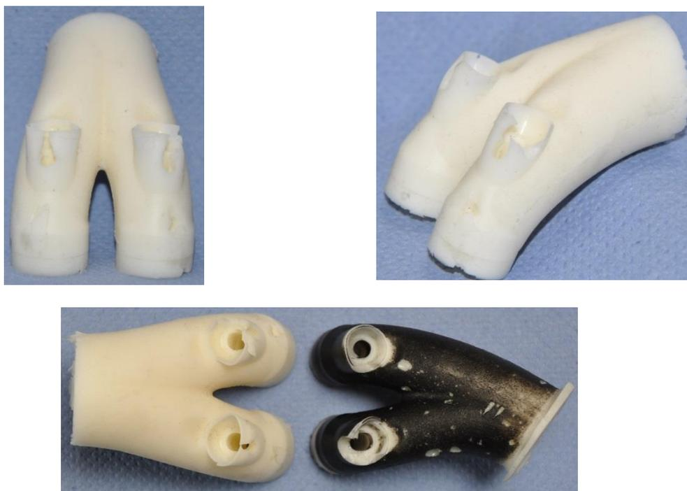
**Abbildung 3.1 Ein- und Auslasskanal Abguss FZ150**
