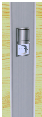
Abb. 231 | Installationsschacht in Wand mit Lichtschalter und Schuko-Steckdose
