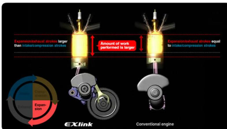
Abbildung 2.11: EXlink Motor im UT des Expansionshubes [17]
