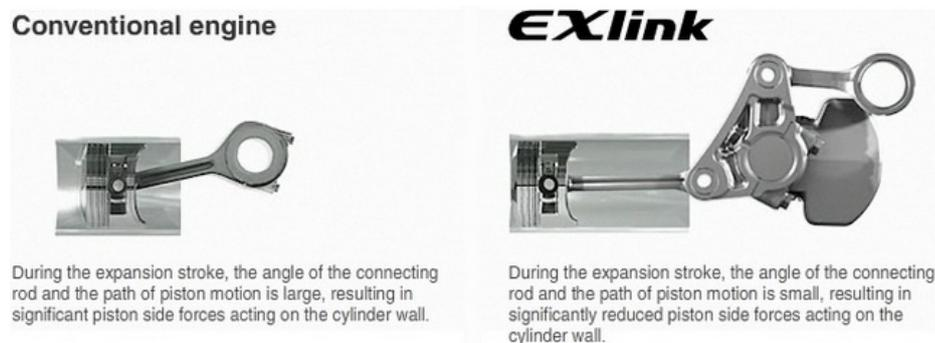
Abbildung 2.12: Pleuelwinkel EXlink und konventioneller Motor [17]
