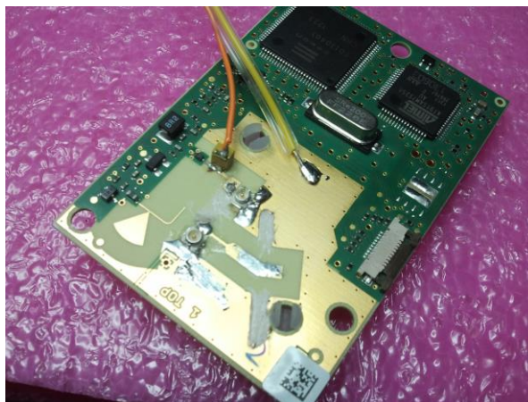
Abbildung 67: Adaptierte Platine mit Anschlussleitungen zum Biasing und eingefügter Induktivität
