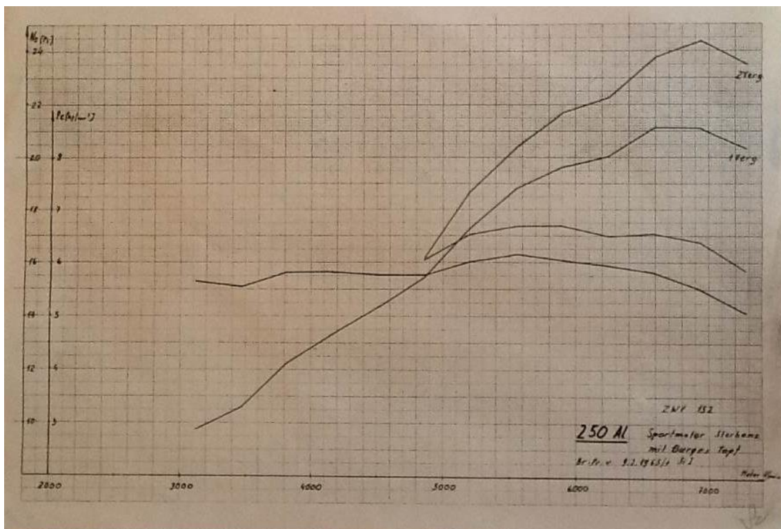
Abbildung 4-12: Leistungs- und Drehmomentkurve Puch 250 Alu-Chromzylinder Sportmotor Messung A. Sterbenz mit einem Vergaser und 2 Vergasern, Burges-Topf, 9.2.1965 [18]
