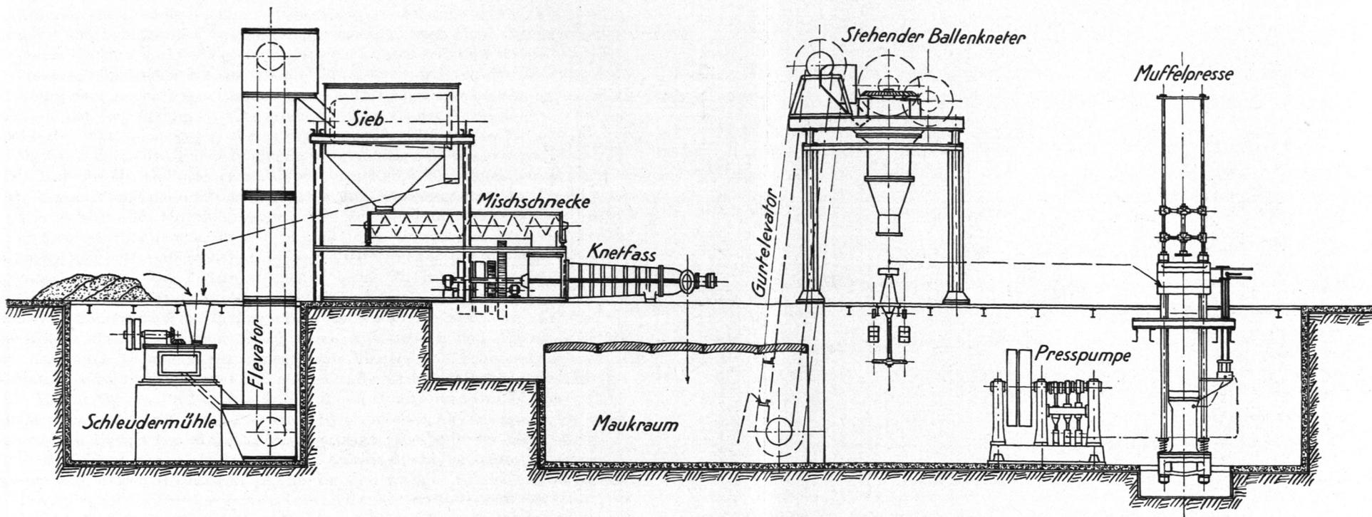
Fig. 108. Übersichtsschema einer Anlage zur Herstellung von Zinkmuffeln auf mechanischem Wege. — Nach Mehler, Aachen. Maßstab 1 : 100.
