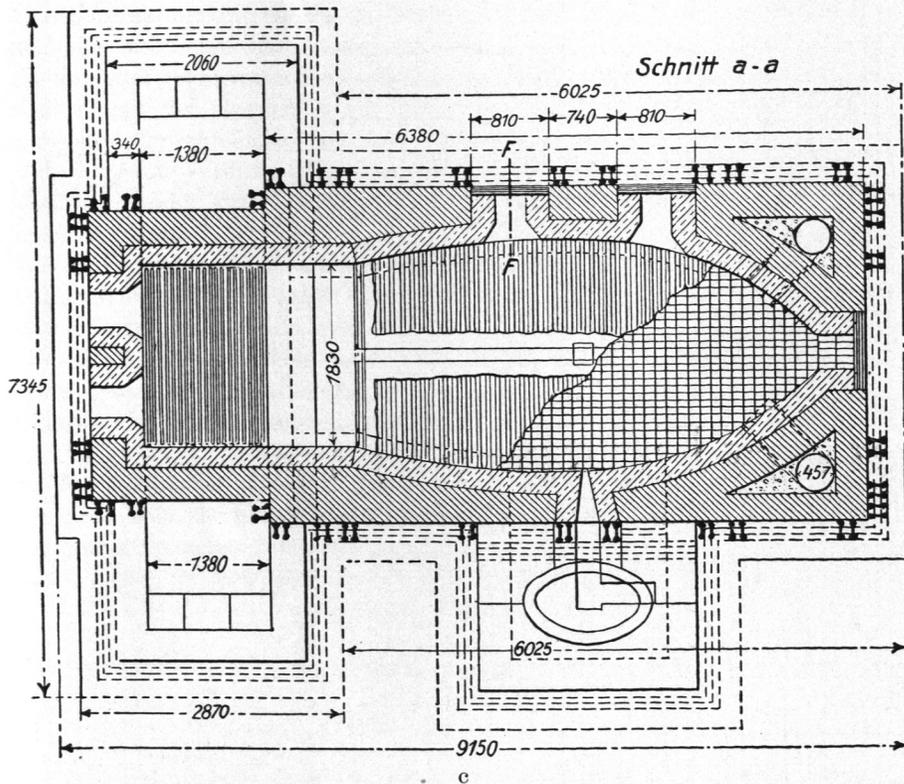
Fig. 73a—c. Flammofen zum reduzierenden Verschmelzen von Zinnerzen (Pulo Brani, Malaien-Staaten). — Nach Louis, Met. of Tin. Maße in mm. Durchsatz in 24 Stunden: 12,7 t Zinnerz. Der Keller ist ständig 2,45 m hoch mit Wasser gefüllt, die weiten 18"-Rohre dienen für die Abführung des Wasserdampfes. Größte Breite des Herdes 2974 mm, Herdfläche 11,660 qm.
