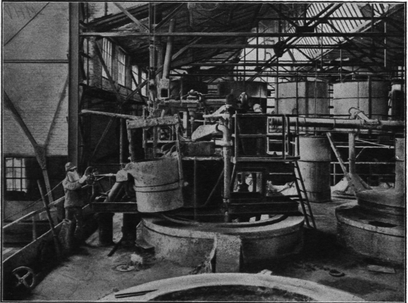
Fig. 56. Harris-Anlage im Betrieb. — Nach Schott, Metall und Erz, Bd. 23. Nach Beendigung der Raffination wird die Salzschnacke in den Kübel gedrückt.
