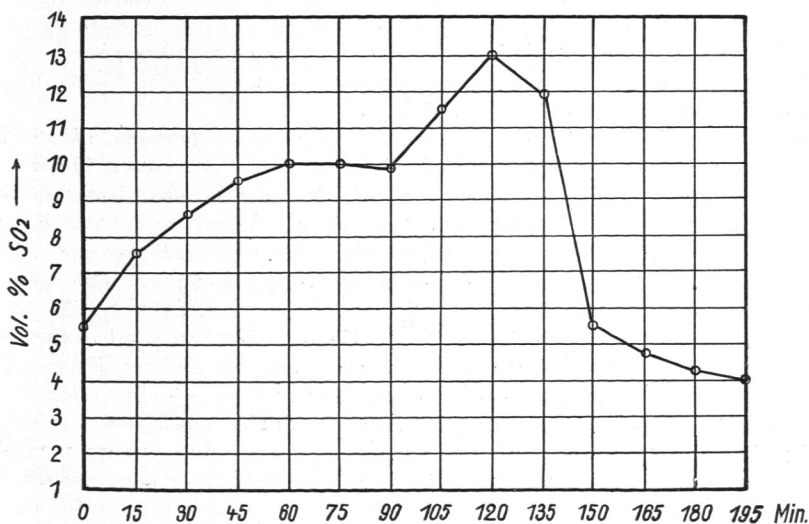
Fig. 25. SO 2 -Gehalte der Röstgase während des Verblasens eines 1,5 t-Sintertopfes. — Nach W. Heyer.
