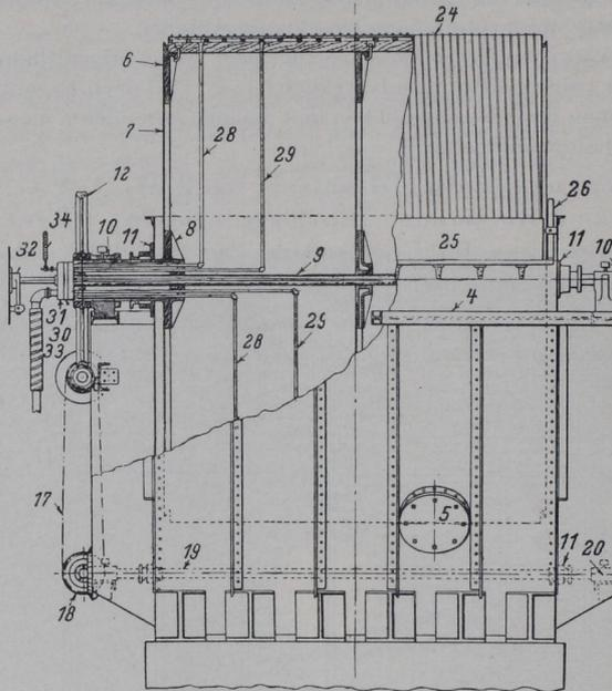
Fig. 24. Oliver-Vakuum-Filter; Schnitt in Richtung der Achse.
