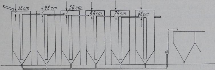
Fig. 20. Beispiel kontinuierlicher Rührlaugung in 6 Pachuca-Tanks.
