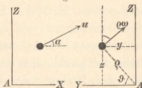
Fig. 372 stellt das Achsenkreuz in zwei Projektionen dar. Bildet  $\rho$  mit der  $A Y$  den Winkel  $\vartheta$ , so ist  $\rho \cos \vartheta = y$ ,  $\rho \sin \vartheta = z$ ; somit zerlegt sich  $\rho \omega$  in  $-z\omega$  und  $y\omega$ . Die Seitengeschwindigkeiten eines Punktes nach den Achsenrichtungen werden dann
