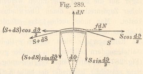
und  $f dN$  noch die Spannkräfte  $S$  und  $S + dS$ . Zerlegt man sämmtliche Kräfte  $\parallel$  und  $\perp$  zu  $dN$ , so verlangt das Gleichgewicht
