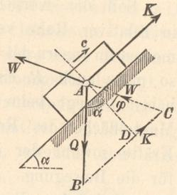
so wird nach dem Sinus-Satze  $K : Q = \sin(\alpha + \varphi) : \sin(90^\circ - \varphi)$ ,
