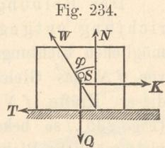
Ergiebt sich, dass zum gleichmässigen Fortziehen eines 62 kg schweren Schlittens auf einer wagerechten Eisfläche eine wagerechte Zugkraft  $K = 2$  kg erforderlich ist, so beträgt die Reibungsziffer  $f = \frac{T}{N} = \frac{K}{Q} = \frac{2}{62} = \frac{1}{31}$ .
