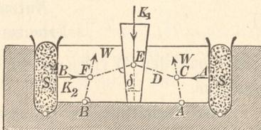
Krafteck (Fig. 269 a) dar, so sind  $JO$  und  $GO$  die Gegendrücke  $D$  der beiden Seitenkeile, welche von der Wagerechten um  $\delta + \varphi$  abweichen. Dadurch ist der Pol  $O$  bestimmt. Die Widerstände  $W$  der wagerechten Gleitflächen bilden mit der Lothrechten die Winkel  $\varphi$  und legen dann mit den Wagerechten durch  $G$  und  $J$  die Punkte  $L$  und  $M$  fest, wodurch  $JL = GM = K_2$  bestimmt werden. Es ist dann im Dreieck  $OGJ$ :
