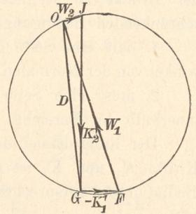
**Zahlenbeispiel:** Bei  $f = 0,2$  oder  $\varphi = 11^\circ$  und  $\alpha_1 = 17^\circ$  mit  $\text{tg } \alpha_1 = 0,3$  wird  $\text{tg } (\alpha_1 + 2\varphi) = \text{tg } 39^\circ = 0,8$ , mithin  $K_1 = 0,8$ ,  $K_2$  für Hinaufkeilen;  $\text{tg } (\alpha_1 - 2\varphi) = -\text{tg } (5^\circ) = -0,09$ , d. h.  $-K_1 = 0,09$ ,  $K_2$  für Hinunterlassen.
