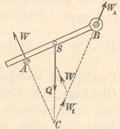
von gleicher Einfachheit ist, welche Richtung auch der Schlitz haben mag, wenn man nur die Richtung eines der Widerstände  $W$  oder  $W_1$  bestimmt zu erkennen vermag (Fig. 186).
