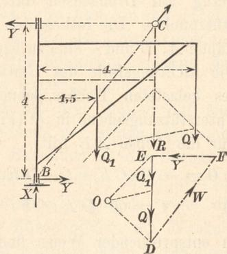
rechte Widerstand  $Y$  des oberen Lagers und der schräge Gesamtwiderstand  $W$  des unteren Lagers im Gleichgewichte sein, sich also auf ihr schneiden. Der Schnitt  $C$  von  $Y$  und  $R$  bestimmt sonach die Richtung  $BC$  von  $W$ . Zieht man im Krafteck  $EF$  wagerecht,  $DF \parallel BC$ , so ist  $DF = W$  und  $FE = Y$ .
