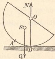
Die Vertauschung der unteren Kugelfläche mit einer Cylinderfläche entspricht der obigen Ersetzung eines Befestigungspunktes  $A$  durch eine Drehachse.
