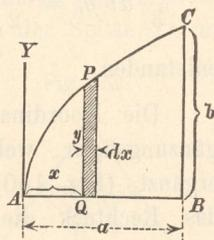
Zur Auffindung der Ordinate  $y_0$  des Schwerpunktes trenne man einen Streifen ab, dessen Theilchen den gleichen Abstand  $y$  von  $AB$  haben (Fig. 149). Dann wird
