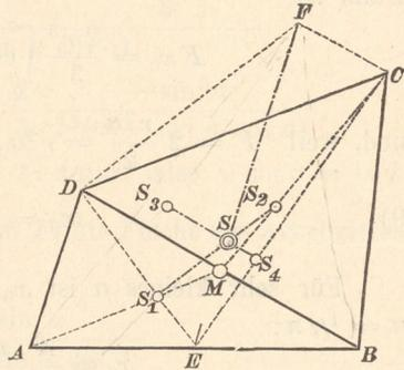
Die Theilschwerpunkte  $S_1$  bis  $S_4$  in Fig. 143 haben also nur zur Herleitung des Verfahrens gedient, sind aber für die Ausführung unnöthig.
