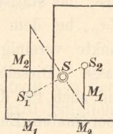
Legt man die  $yz$ -Ebene so, dass die Theilschwerpunkte zu beiden Seiten der Ebene liegen (Fig. 135), so haben  $x_1$  und  $x_2$  verschiedenes Vorzeichen, und es ist  $Mx_0 = M_2x_2 - M_1x_1 = \Sigma mx$ . Ist die  $yz$ -Ebene dann noch so gelegt, dass  $M_1x_1 = M_2x_2$ , so wird  $Mx_0 = \Sigma mx = 0$ , mithin  $x_0 = 0$ , d. h. der Schwerpunkt liegt in der  $xy$ -Ebene, daher der vielfach anzuwendende Satz:
