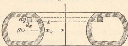
Achse entsteht, ist gleich der Länge der Kurve mal dem Drehungswege  $2\pi x_0$  ihres Schwerpunktes. — Der Inhalt eines Körpers, welcher durch Drehung einer ebenen Fläche um eine in ihrer Ebene liegende Achse entsteht, ist gleich der Fläche mal dem Drehungswege ihres Schwerpunktes.
