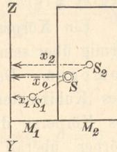
Hiernach kann man  $S$  leicht finden, indem man (Fig. 134) durch  $S_1$  und  $S_2$  beliebige Parallelen zieht und auf ihnen die Grössen  $M_2$  bzw.  $M_1$  (d. h. die vertauschten Massen) als Längen nach entgegengesetzten Seiten aufträgt. Die Verbindungsgerade der Endpunkte schneidet dann  $S_1 S_2$  in  $S$ .
