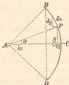
**Schwerpunkte von Flächen.** Hat der homogene Körper die Gestalt einer ebenen oder gekrümmten Platte  $F$  von überallgleicher Dicke  $\delta$ , so wird  $V = \delta F$ ,  $dV = \delta dF$ , mithin
