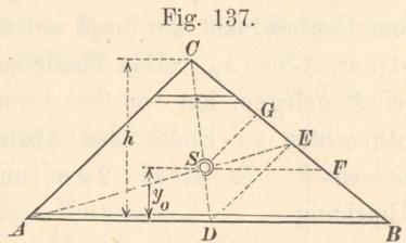
Da das Dreieck nur einen Schwerpunkt haben kann, so liegt hierin nebenbei der Beweis des geometrischen Satzes, dass die 3 Mittellinien eines Dreiecks sich in einem Punkte schneiden. Wegen den innigen Beziehungen zwischen Geometrie und Mechanik kommt es nicht selten vor, dass Sätze der Mechanik in einfacher Weise zur Lösung geometrischer Aufgaben benutzt werden können.
