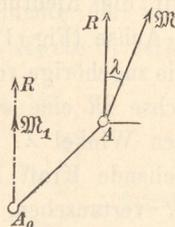
Steht die ursprünglich gefundene Momentenachse  $\mathfrak{M}$  rechtwinklig zu  $R$ , ist also  $\lambda = 90^\circ$ , so wird  $\mathfrak{M}_1 = \mathfrak{M} \cos \lambda = 0$  und  $r = \mathfrak{M} : R$ ; d. h. in diesem Falle verschwindet das Achsenmoment  $\mathfrak{M}_1$ , und die gegebene Kräftegruppe hat sich auf eine Einzelkraft  $R$  zurückführen lassen.
