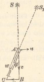
wohnt ist, einen im Fernrohre erblickten Gegenstand als in der Richtung des Fernrohres befindlich anzunehmen, so vermuthet man  $S$  vielleicht an die Stelle  $S_1$ . Der Winkel  $\varphi$ , um den die scheinbare Richtung des Sternes von der wahren abweicht, heisst die *Aberriation des Lichtes*. Die sekundl. Geschwindigkeit der Erde beträgt 29,7 km, die des Lichtes 311 400 km, daher ist
