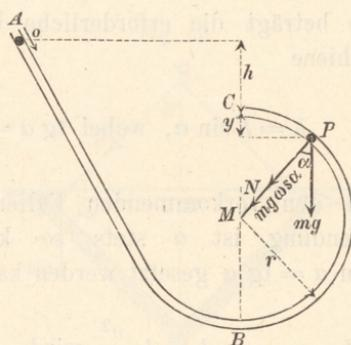
Der Normalwiderstand der Röhre sei  $N$  (nach innen gerichtet); dann zerlegt sich  $mg$  in  $mg \sin \alpha$  (tangential und verzögernd) und  $mg \cos \alpha$  (centripetal). Es wird  $\frac{v^2}{r} = \frac{N + mg \cos \alpha}{m}$ , mithin
