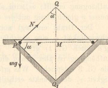
Einer solchen Kegelfläche müssen auch die Oberkanten der beiden Schienen eines Eisenbahngleises angehören, wenn die Mittellinie desselben in einem wagerechten Kreisbogen vom Halbmesser  $r$  liegt.
