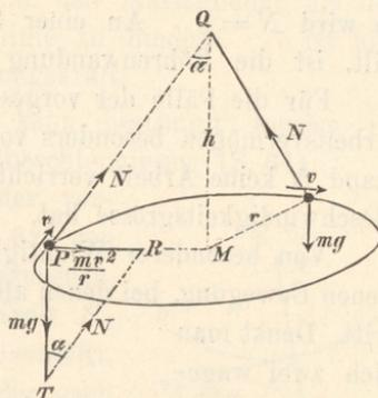
den festen Punkt  $Q$  dieser Achse, dessen Höhe  $h$  dadurch bestimmt ist, dass bei  $Q$  der Winkel  $\alpha$  sich wieder findet. Es muss dann sein (mit Rücksicht auf Gleichung 1):
