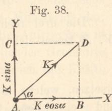
einschliessen, so fällt man von  $H$  ein Loth  $HD$  auf die  $xy$ -Ebene und hat damit die in die  $z$ -Achse fallende Seitenkraft  $K \cos \gamma$  mit dem Sinne von  $D$  nach  $H$ . Eine Parallele durch  $D$  zur  $y$ -Achse liefert die Seitenkraft  $BD = K \cos \beta$  für die  $y$ -Richtung, und endlich ist  $AB = K \cos \alpha$  die Seitenkraft in der  $x$ -Richtung (vergl. S. 23, Fig. 25).
