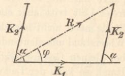
Wird  $\alpha = 0$ , d. h. haben die beiden Kräfte übereinstimmende Richtung und gleichen Sinn, so wird die Mittelkraft die wirkliche
