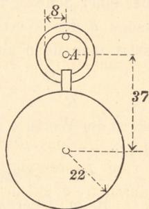
macht sich auch geltend, wenn man die Uhr nach Fig. 201 aufhängt; stimmt die Schwingungsdauer der aufgehängten Uhr mit derjenigen der Unruhe überein, so kann die aufgehängte Uhr unter günstigen Umständen in Folge der Bewegung der Unruhe in deutlich sichtbare Schwingungen gerathen.
