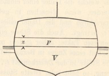
so vergrössert sich in Folge einer Vermehrung der Eintauchung um  $z$  der Auftrieb um  $\gamma Fz$ . Dies ist also die Kraft, welche den Körper in die Gleichgewichtslage zurückzuführen strebt und ihm eine Beschleunigung
