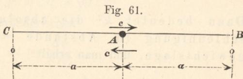
Während der Zeit  $\frac{2\pi}{k}$  wird die Bahnlinie  $BC$  von dem Massenpunkte hin und her durchlaufen. Eine solche Bewegung nennt man eine Schwingungsbewegung. Der Massenpunkt schwingt um die Gleichgewichtslage als Mitte; es ist  $\frac{2\pi}{k}$  die Zeit einer Doppelschwingung,
