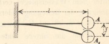
(2. Theil, S. 43, Gl. 7) tiefer als  $A$ , wenn  $l$  die Länge des Stabes,  $J$  das Trägheitsmoment seines Querschnitts. Die Schwingungsdauer entspricht einer Pendellänge  $f$ .
