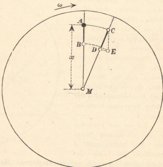
**Beispiel 3:** Die scheinbare Bahnlinie sei ebenfalls ein Halbmesser einer sich gleichmässig drehenden Scheibe; die scheinbare Bewegung erfolge aber nicht nach aussen, sondern nach der Mitte hin (Fig. 51) mit der gleichbleibenden Geschwindigkeit  $w$ . Man findet  $v$  mittels Fig. 52. Es ist wiederum  $p_1 = 0$ ;  $p_2 = x \omega^2$  centripetal;  $p_3 = 2w \cdot \omega$  aber nach links gerichtet, weil
