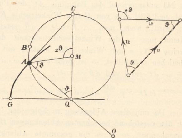
aus der scheinbaren Geschwindigkeit  $w$  in der Richtung  $AB$  und der wagerechten Verschiebungsgeschwindigkeit  $w$  nach rechts. Bildet die scheinbare Geschwindigkeit  $w$  mit der Wagerechten den Winkel  $2\vartheta$ , so schliesst  $v$  mit der Wagerechten den Winkel  $\vartheta$  ein und hat die Grösse
