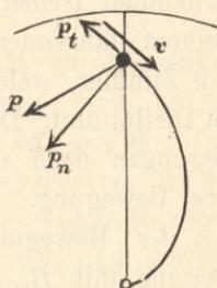
sich bei der Drehung um  $C$  der Endpunkt  $E$  von  $E$  nach  $D$  bewegt. Die Richtung von  $p$  wird wiederum rechtwinklig zu  $HJ$  in dem Geschwindigkeitsdreieck Fig. 52, an welches man  $JF = w$  anreicht. Die Zerlegung von  $p$  liefert diesmal in tangentialer Richtung eine Verzögerung (Fig. 53), weil die Geschwindigkeit  $v$  mit kleiner werdendem  $x$  abnimmt. Die wahre Bahnlinie ist wiederum eine archimedische Spirale.
