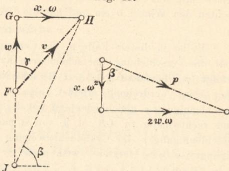
Man hat sich im Sinne der Herleitung auf S. 39 den Übergang des Theilchens  $AB$  in die Nachbarlage  $CD$  (Fig. 48) in der Weise vorzustellen, dass man demselben eine Verschiebung um den Bogen  $AC$  in die Zwischenlage  $CE$  ertheilt denkt und nun um eine durch  $C$  gehende augenblickliche Drehachse, rechtwinklig zur Bildebene, eine
