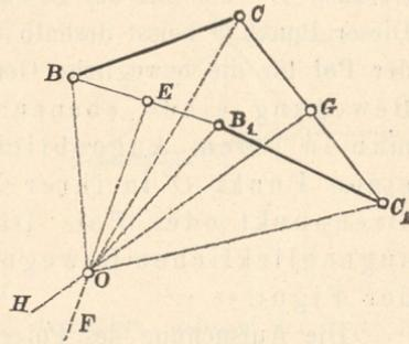
Bei dieser Drehung um  $O$  beschreiben  $B$  und  $C$  Kreisbögen um  $O$  als Mittelpunkt (Fig. 13). Die Drehungshalbmesser  $BO$  und  $CO$  der Anfangslage sind rechtwinklig zu den kreisförmigen Bahnlinien  $BB_1$  und  $CC_1$ .
