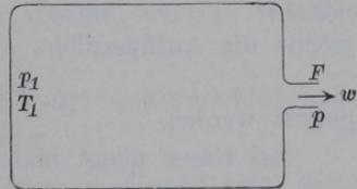
wie beim Ausflusse von Wasser, eine Geschwindigkeitsziffer  $\varphi$  hinzugefügt werden, welche nach Grashof, Theoretische Maschinenlehre, 1. Band, S. 585, auf Grund Weisbach'scher Versuche zu etwa
