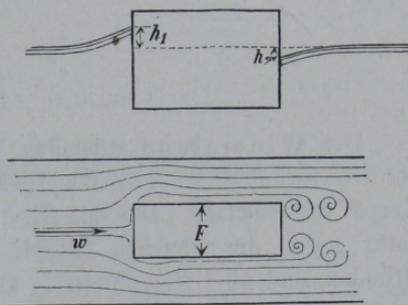
wenn  $\gamma$  die Dichte der Flüssigkeit,  $F$  der grösste Querschnitt des eingetauchten Theiles des festen Körpers, rechtwinklig zur Geschwindigkeit  $w$  gemessen. Für ein Prisma mit ebenen, rechtwinklig zu  $w$  stehenden Endflächen kann mit einiger Wahrscheinlichkeit  $\zeta_1 = 1$  gesetzt, d. h. angenommen werden, dass die Druckvermehrung  $P_1$  an der Vorderseite einer Druckhöhe  $h_1 = \frac{w^2}{2g}$  entspricht, während
