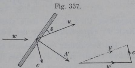
Winkel  $\varepsilon$ , so hat die Seitengeschwindigkeit  $u \cos \varepsilon$  des Wassers parallel zur Platte keinen Einfluss; es wird der Druck  $N$  nur durch die Seitengeschwindigkeit  $u \sin \varepsilon$  rechtwinklig zur Platte bedingt. Ist wiederum  $F$  die Grösse der Platte,  $\gamma$  die Dichte der Flüssigkeit, so wird auf Grund von Gl. 3 (S. 326)
