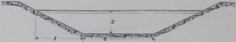
$= 0,447$ ) (Fig. 321) Wasser entnommen werden. Auf  $l = 5000$  m Länge steht ein Gefälle  $h = 1$  m zur Verfügung.
