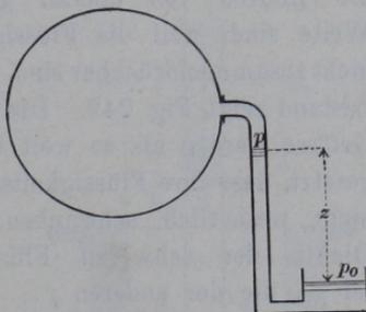
Zum Messen von Drücken in Kondensatoren, Feuerzügen, Schornsteinen u. dgl., welche kleiner sind als der Atmosphärendruck, dienen **Minderdruck-Messer (Vakuummeter)** (Fig. 240). Es ist
