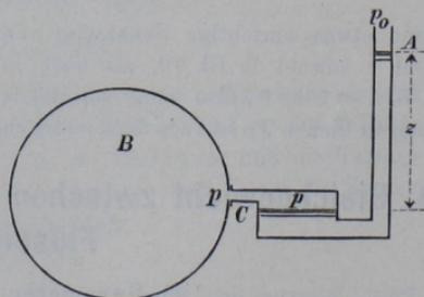
Soll der Druck  $p$  des in dem Behälter  $B$  (Fig. 239) befindlichen Dampfes oder Gases gemessen werden, so verbindet man mit dem Behälter einen oben bei  $A$  offenen Druckmesser. Dann wirkt bei  $A$  der Atmosphärendruck  $p_0$ , und bei  $C$ , in einer Tiefe  $z$  unter dem Flüssigkeitsspiegel bei  $A$ , ist der Druck
