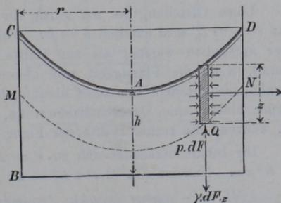
Für überall gleiche  $z$  bekommt auch  $p$  überall denselben Werth. Flächen gleichen Druckes haben also in allen Punkten gleiche lothrechte Tiefe unter der Oberfläche, d. h. dieselbe Form  $MN$  wie die Oberfläche  $CD$ , sind nur in lothrechtem Sinne dagegen verschoben.
