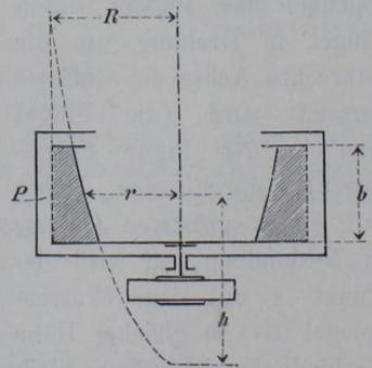
gelangt. Als flüssigen Körper wollen wir uns Rübenmasse denken, welche den schraffirten ringförmigen Körper bildet, der annäherungsweise als ein Ring von der Wandstärke  $R - r$  angesehen werden kann. Der drehbare Cylinder ist von einem festen Gehäuse umgeben, in welches der Saft durch die Öffnungen des Mantels eintritt. Der Druck an dem Punkte  $P$  beträgt
